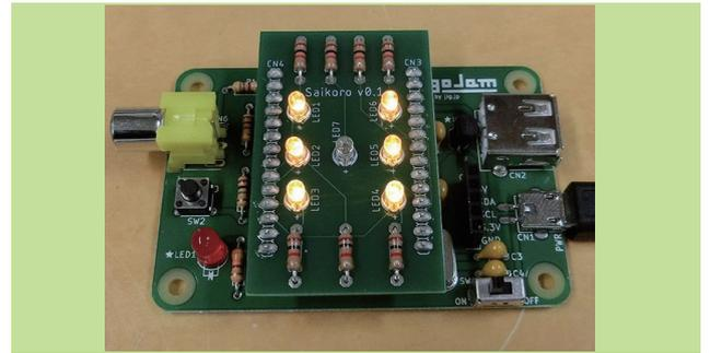
LED さいころ基板をはんだづけ工作して、マイコン「IchigoJam」(イチゴジャム)にさして、プログラムで動かします。
