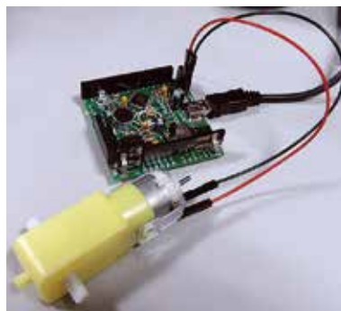
プログラムでモーターを回します
