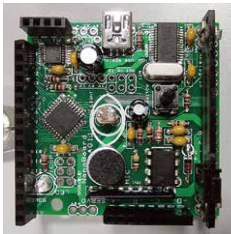
組み立てた「なのぼ〜どAG」 センサーやボタンなどが のったマイコンです
